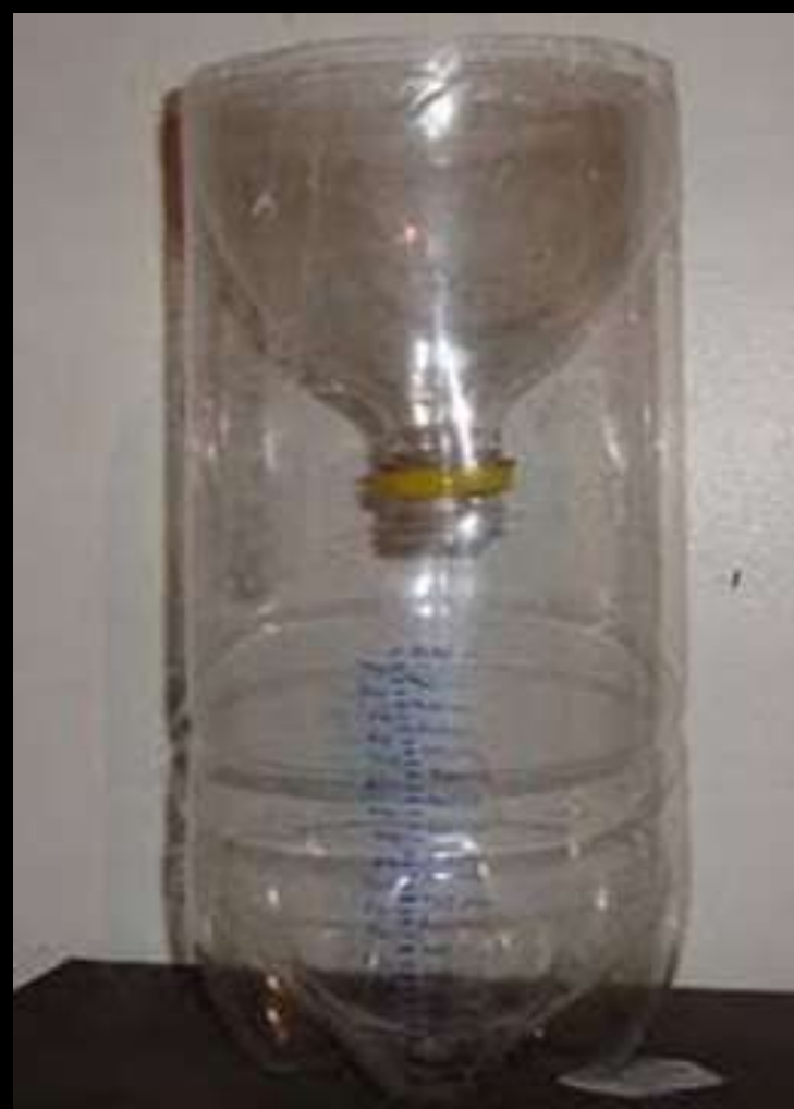
Figura 8: foto do pluviômetro caseiro construído com garrafa pet
