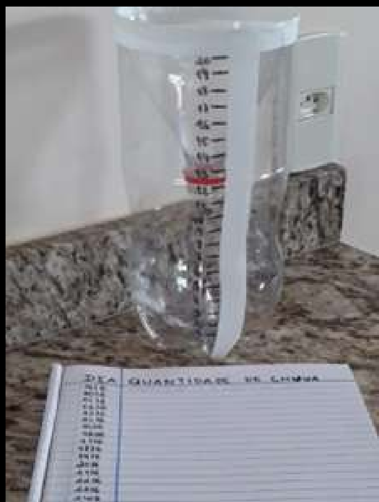
Figura 18: pluviômetro caseiro com garrafa pet e tabela de precipitação da quantidade de chuvas
